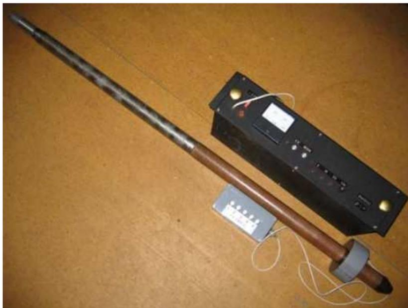
Аппаратура применяется как в гидрозалполненных, так и в сухих скважинах, а также в скважинах с полиэтиленовыми обсадными трубами. Благодаря использованию двухкатушечного зонда снижается влияние ближней зоны. Имеет разработанную систему метрологического обеспечения. Для калибровки аппаратуры используются стандарт-сигнал или полевое калибровочное устройство (ПКУ). Градуировка и поверка аппаратуры осуществляется при помощи градуировочного устройства.
